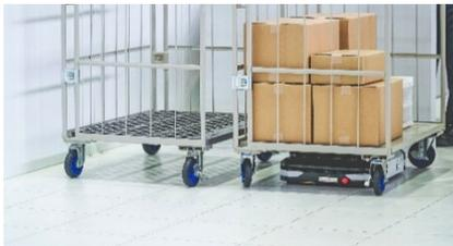
本体高さ136mmの薄さで、お客様が現在お使いのかご台車を改造なしでそのままお使いいただける搬送ロボット。あらゆる荷物を持ち上げ、倉庫の物の移動などの自動化や効率化、省人化を可能にします。
