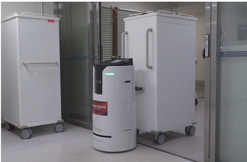
薬剤を載せた台車を牽引し、自動ドアを通過するAISLE Tower Type
